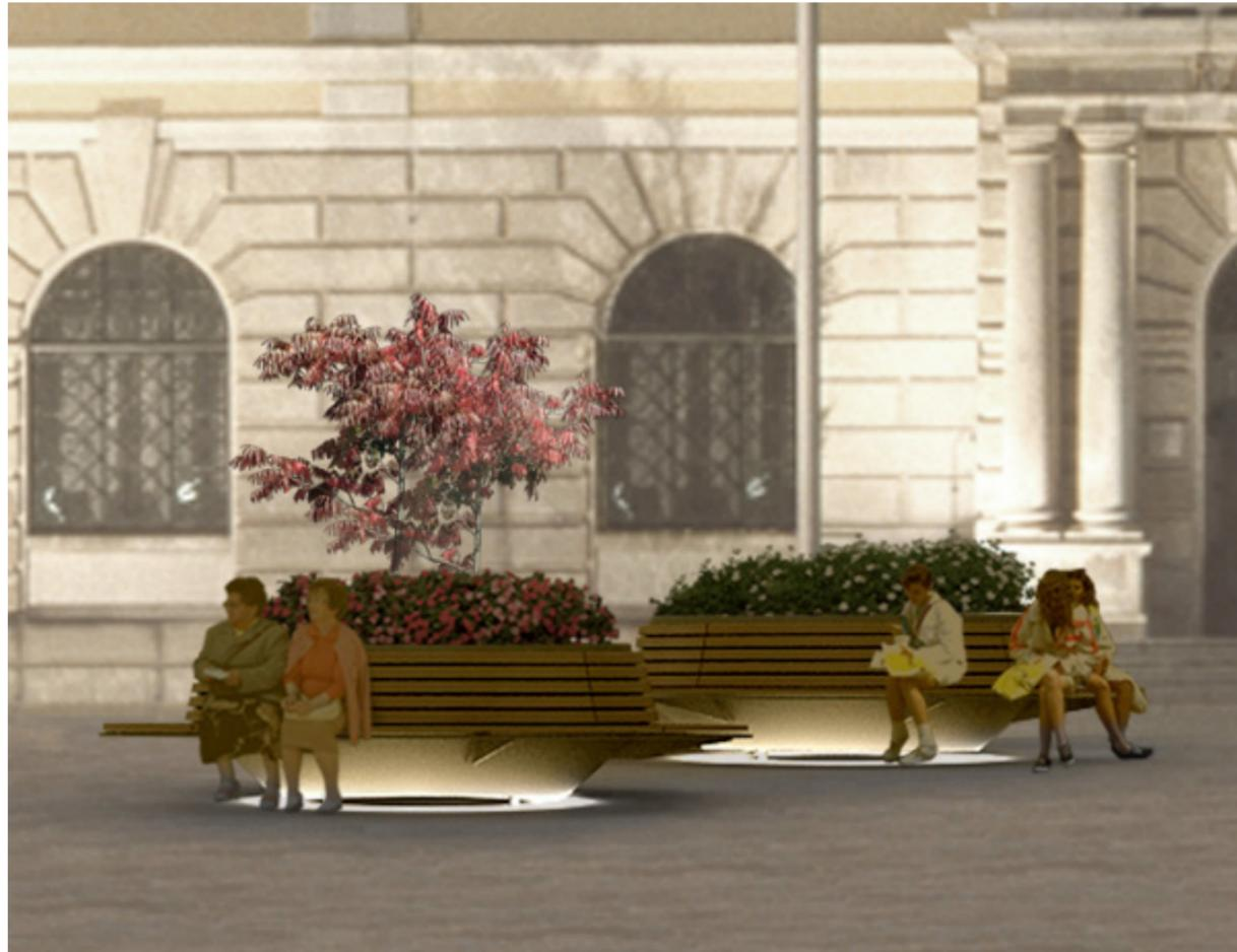
indirekte Beleuchtung über Bodenfuge mit warmweißer LED
