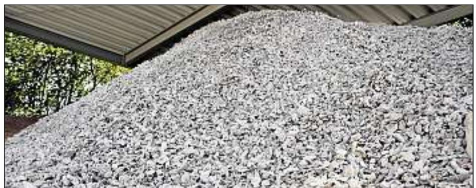
**Unscheinbarer Anblick, wertvoller Inhalt: rund die Hälfte dieser Nichteisenmetalle macht Aluminium aus, das in der MVA separiert und anschließend recycelt wird.**
