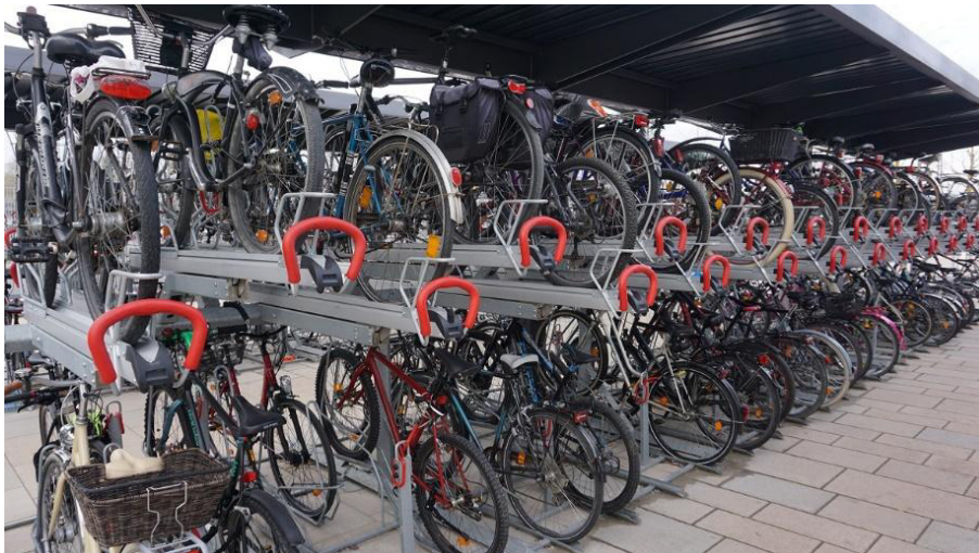
Abbildung 32: Doppelstockparksystem mit Witterungsschutz
