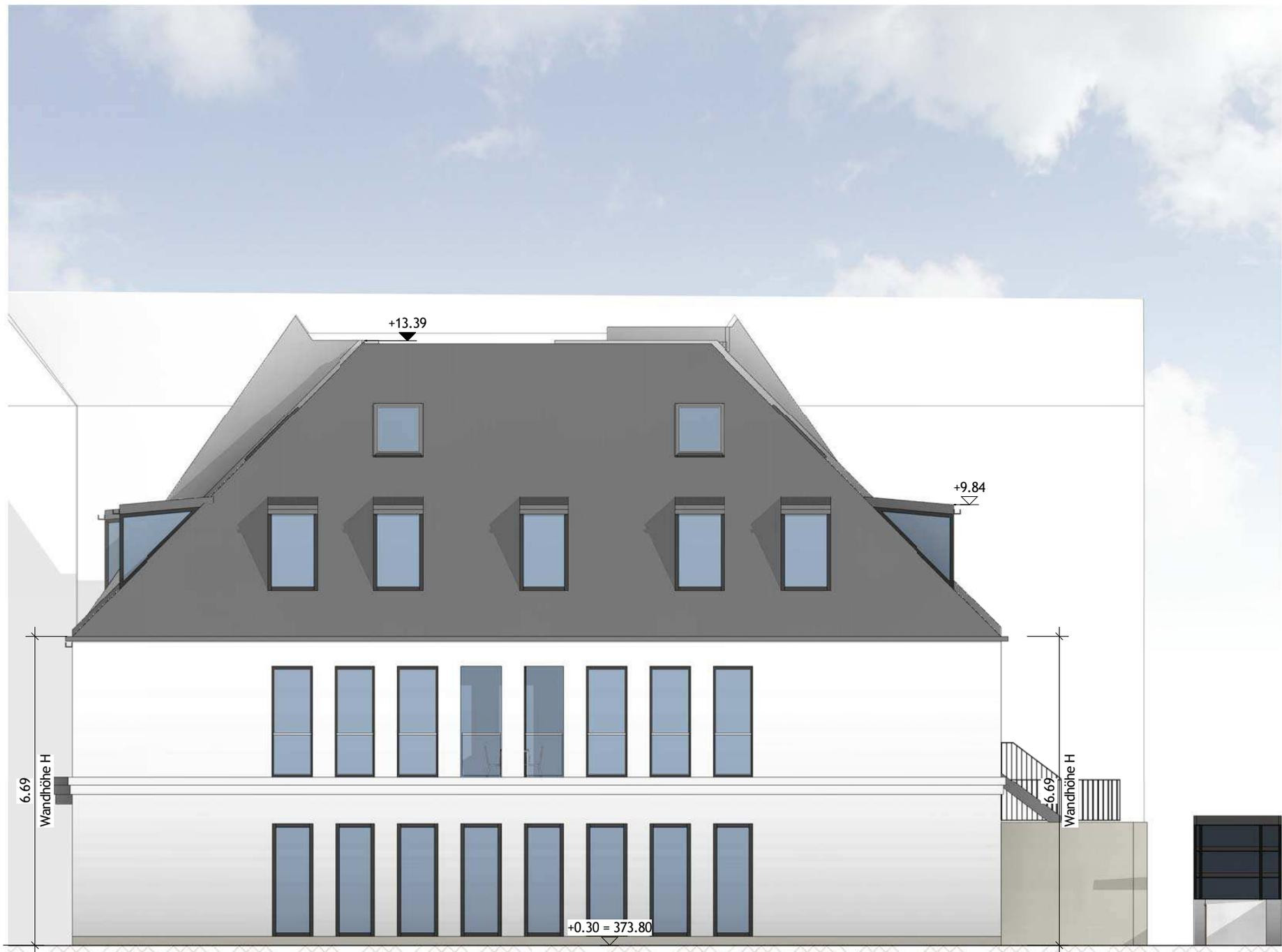
Das bestehende Gelände ist aufgrund der archäologischen Grabungen und der Herstellung der Tiefgarage nicht mehr vorhanden. Somit wird hier nur das geplante Gelände dargestellt.
