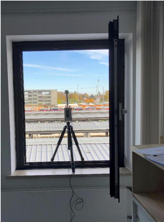
Foto 1: EMF-Messgerät in Fensterebene
