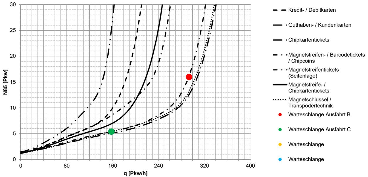
Anzahl der Fahrzeuge in der Warteschlange vor der Einfahrt in Abhängigkeit von der Verkehrsstärke und des Abfertigungssystems bei 85 % statistischer Sicherheit
