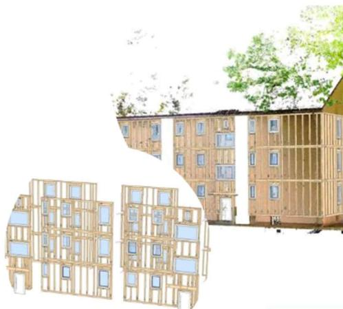
Abbildung 5: 3-D-Modell basierend auf Laserscans der Außenfassaden
