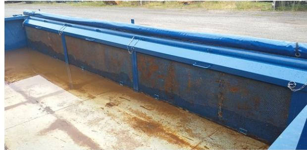
**Bild 7 - Nassbagger als Raupen-Amphibienfahrzeug** **Bild 8 - Absetzcontainer mit Sedimentationsbecken**
