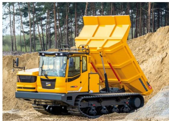
Bild 5 - Kettendumper mit Gummipanzerung Kette
