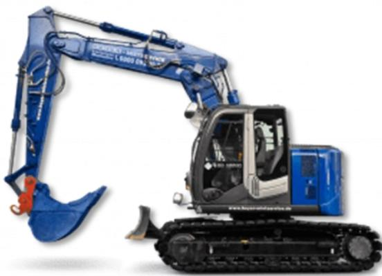
Bild 4 - Kettenbagger mit Gummipanzerung Ketten
